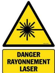
**Le rayon ne doit jamais atteindre les yeux d'un manipulateur ou d'un observateur dans la salle.** Il convient également de prendre garde aux phénomènes de réflexion.
